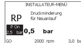
Abbildung 19: Einstellung des Neustartdrucks
